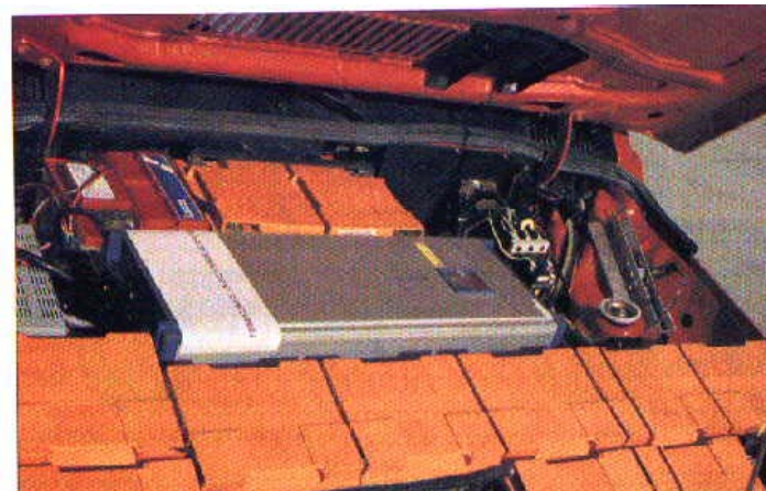
Το σύστημα συσσωρευτών και ο ενσωματωμένος φορτιστής των
